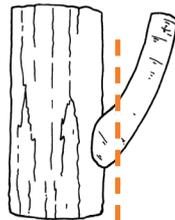
**3- Sur un rejet**, la coupe doit être exécutée parallèlement à l'axe du tronc ou de la branche qui le porte, sans entamer l'écorce.
